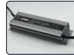
SUR-1260-A/SUR-2460-A Input(AC) : 90-130V/170-250V Output(DC): 12V/24V Power : 60W Size : 187*69*23mm Waterproof : IP67
