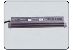
SUR-1250-A/SUR-2450-A Input(AC) : 90-130V/170-250V Output(DC): 12V/24V Power : 50W Size : 165*47*25mm Waterproof : IP67
