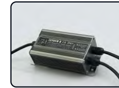
SUR-1280-A/SUR-2480-A Input(AC) : 90-130V/170-250V Output(DC): 12V/24V Power : 80W Size : 187*68.5*43mm Waterproof : IP67
