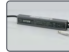
SUR-1220-A/SUR-2420-A Input(AC) : 90-130V/170-250V Output(DC): 12V/24V Power : 20W Size : 192*29*20.5mm Waterproof : IP67
